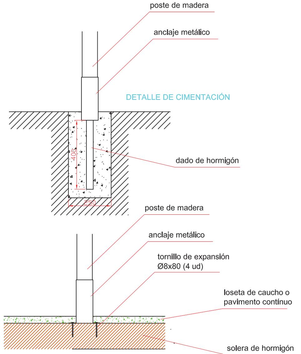
DETALLE DE ANCLAJE ATORNILLADO
